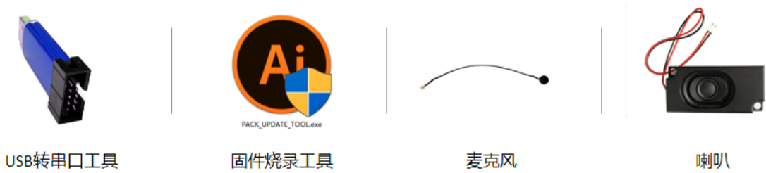
图11 固件烧录需准备的物品
