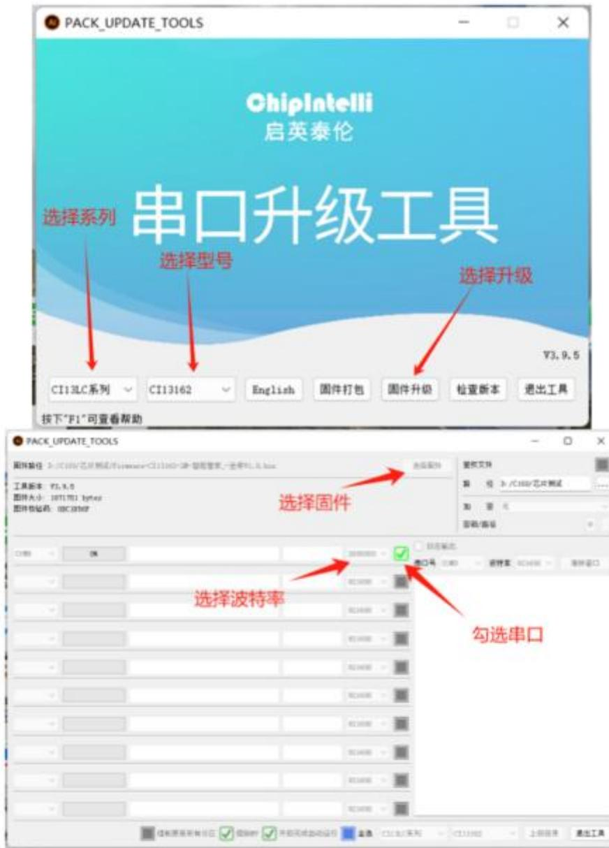
图 12 固件烧录工具示意图
