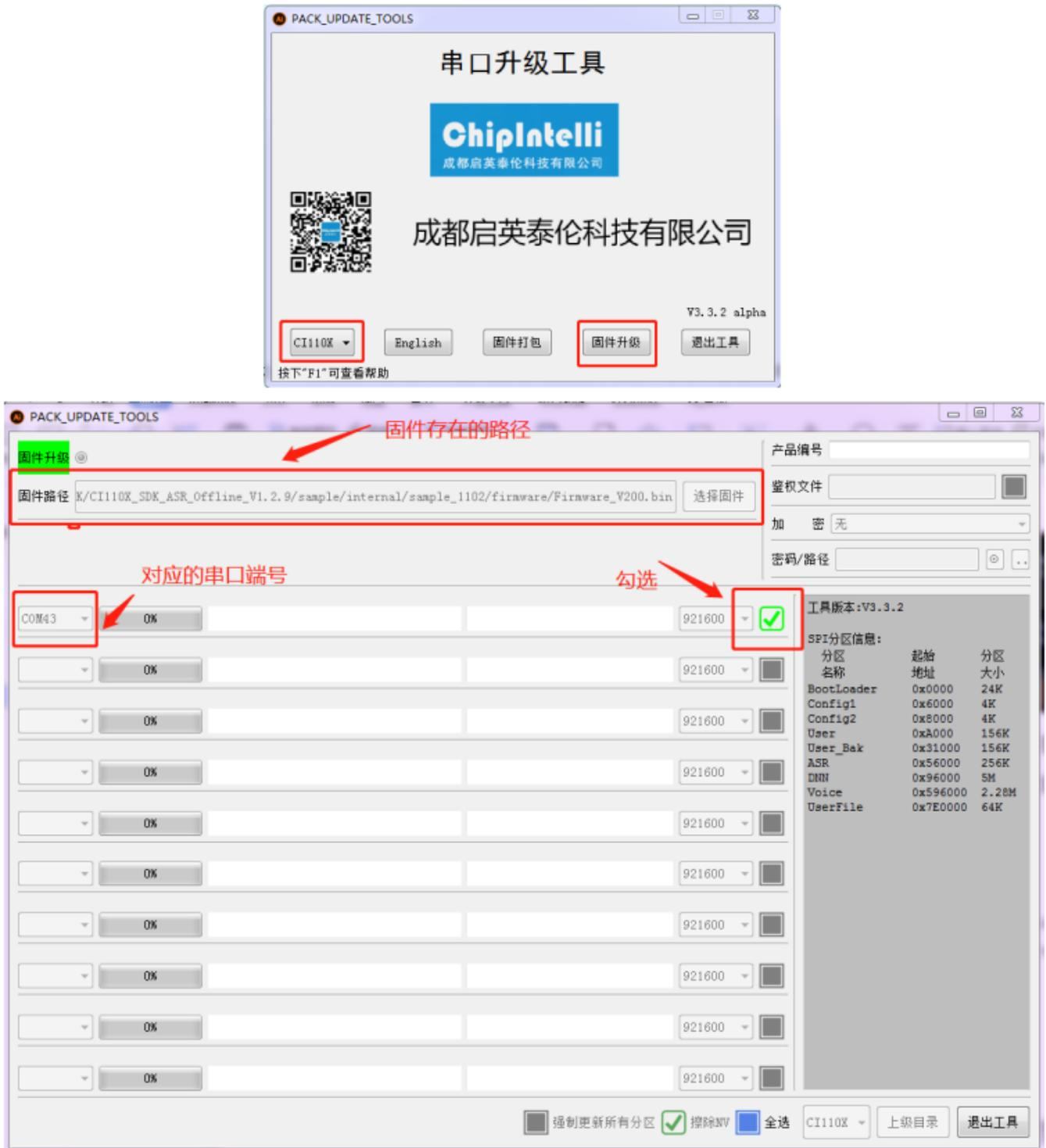
图13 固件烧录工具示意图
