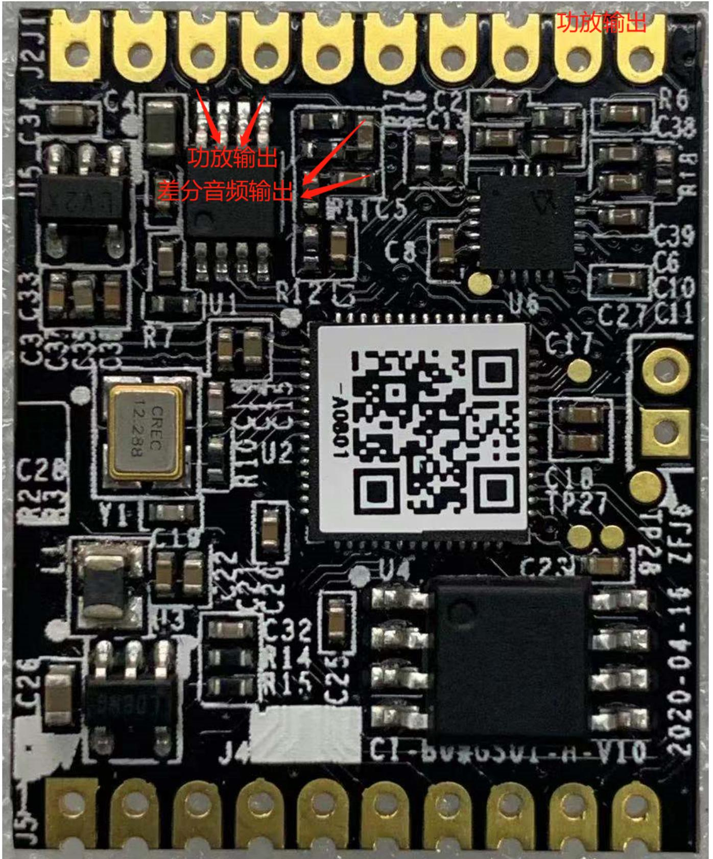
图16 模块语音输出测量点
