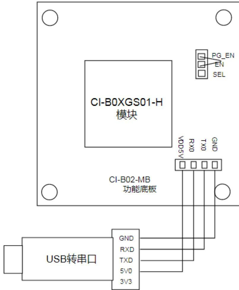
图13 模块和USB转串口工具连接及模块背面丝印图
