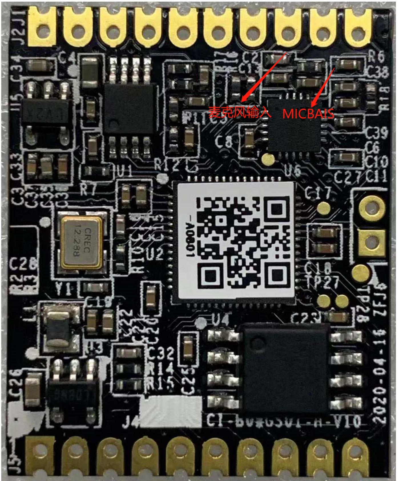
图17 模块麦克风信号测试点
