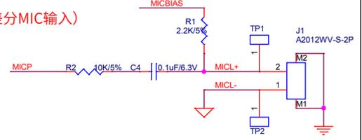
麦克风输入电阻R2可以提高麦克风防静电能力，增加后一般应用场景可不添加ESD器件，高可靠性要求应用建议增加ESD器件。
